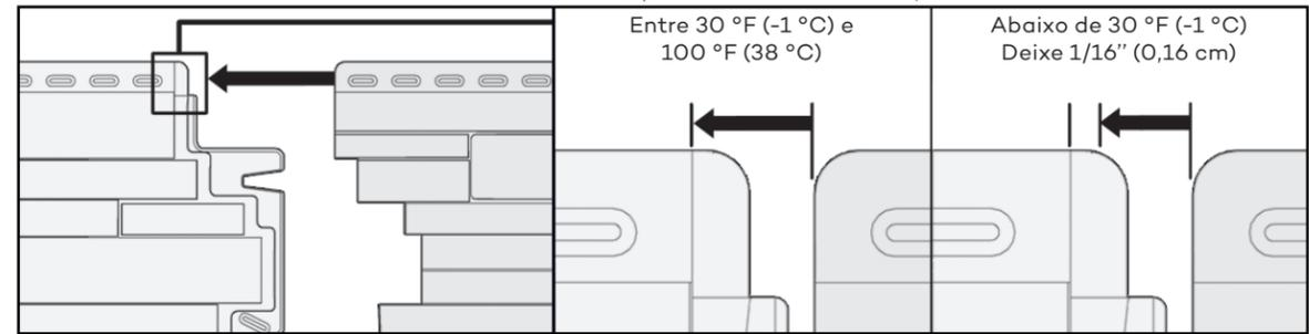
Abaixo de 30 °F (-1 °C), posicione a segunda seção levemente à direita (1/16", ou 0,16 cm) da seção anterior.
