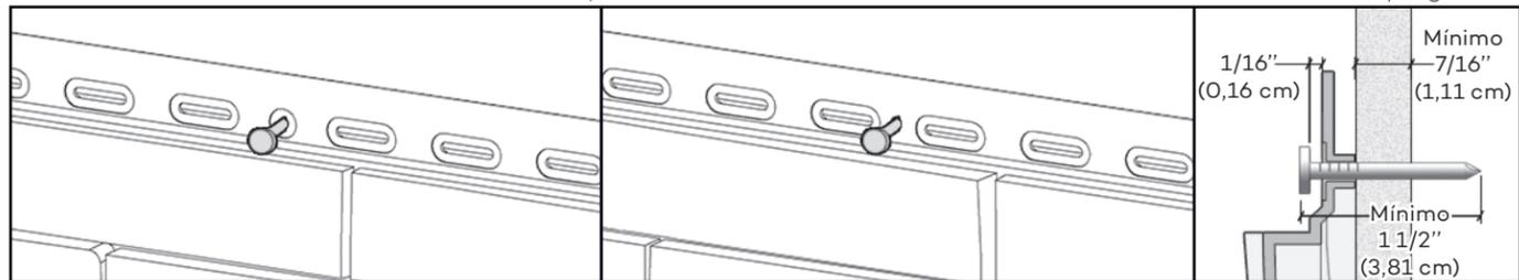
Ao instalar uma seção completa, primeiro coloque o prego no furo central.
