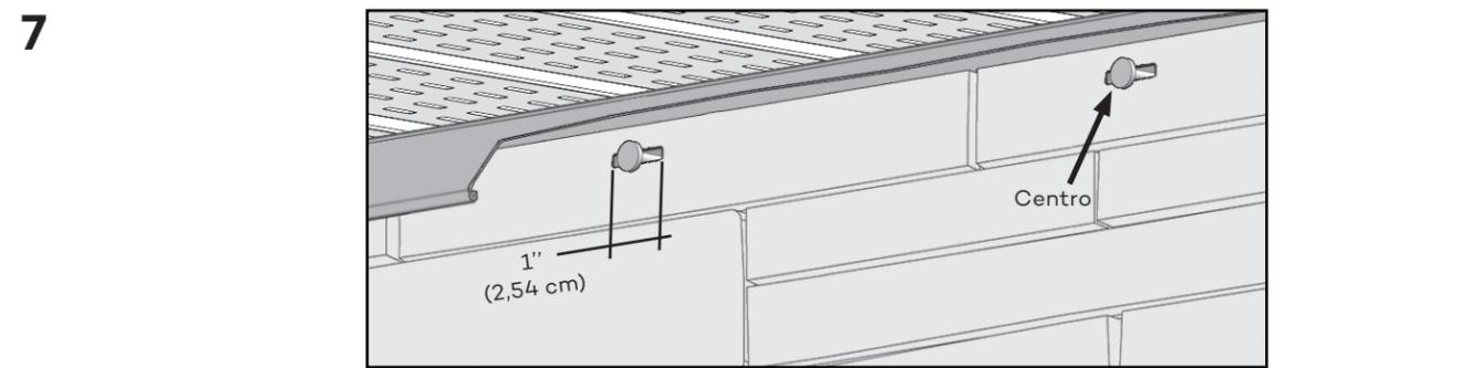
Se precisar fixar a seção em uma área diferente do furo de instalação, crie uma abertura de 1" (2,54 cm) para permitir a entrada do prego. Sempre coloque o prego no meio da abertura.
