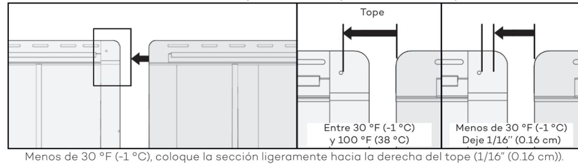
Menos de 30 °F (-1 °C), coloque la sección ligeramente hacia la derecha del tope (1/16" (0.16 cm)).
