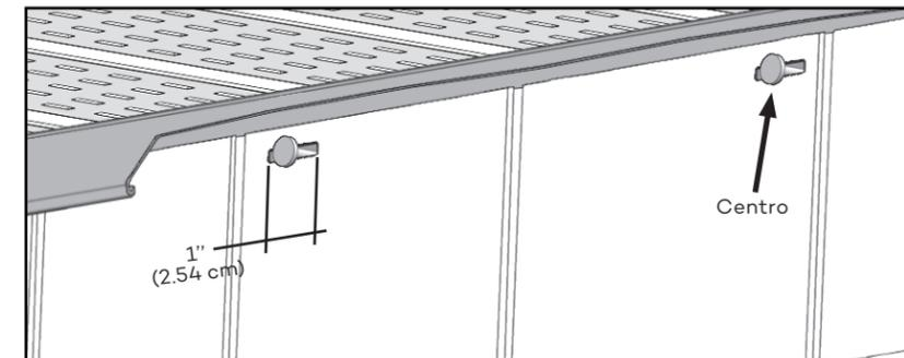
Si necesita sujetar la sección en un área diferente al orificio de instalación, cree una ranura larga de 1" (2.54 cm) para los clavos. Siempre coloque el clavo en medio de la ranura.
