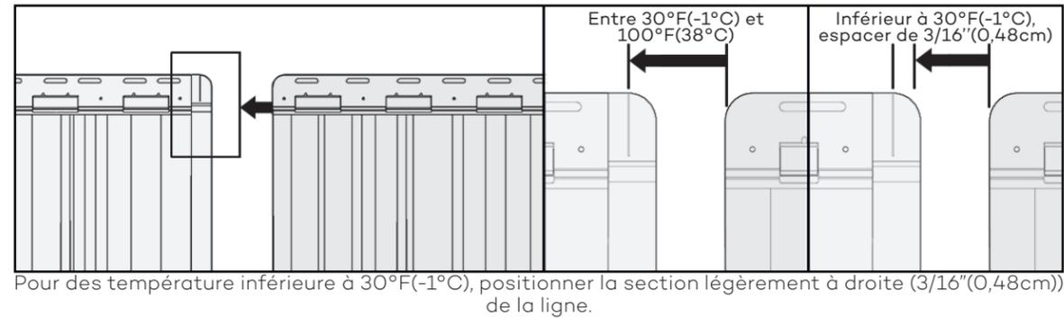
**6** Pour des température inférieure à 30°F(-1°C), positionner la section légèrement à droite (3/16"(0,48cm)) de la ligne.
