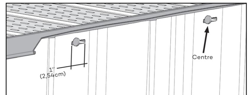
**8** Si vous devez fixer les sections dans un endroit autre que dans les trous de fixation, faire une fente de 1"(2,54 cm) pour permettre de clouer. Toujours clouer au centre de la fente.
