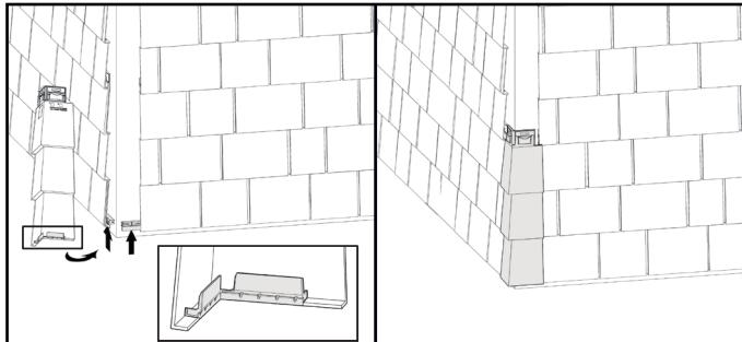
3. При монтаже всех остальных уголков вставьте два крючка в верхние крючки предыдущего уголка. Убедитесь в том, что крючки защелкнулись. Сдвигайте уголок вверх по черепицам покрытия, пока не добьетесь правильного расположения (рисунок H), а затем закрепите обе стороны головки для крепления гвоздями.
