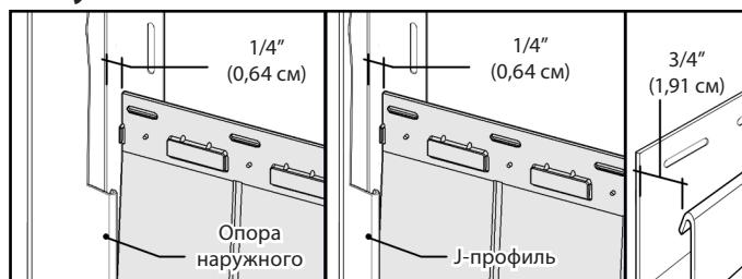
5. Уголки RoughSawn Cedar Dual нужно монтировать на углах стены, прежде чем монтировать секции RoughSawn Cedar Dual. При необходимости ознакомьтесь с разделом, в котором описывается монтаж уголков.
