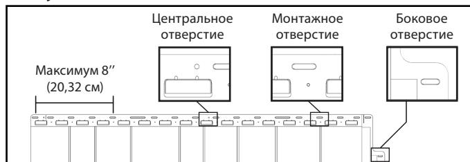
2. Запрещается забивать гвозди или закручивать крепежные детали до конца: нужно оставить зазор 1/16" (0,16 см) между каналом для крепления гвоздями и шляпкой крепежной детали (рисунок 2). Обязательно нужно использовать нержавеющие гвозди или винты со шляпкой диаметром 0,4" (1 см) и стержнем диаметром 0,150" (0,38 см), которые должны проникать в твердую поверхность на расстояние не менее 1 1/4" (3,18 см), а в твердую основу как минимум на 7/16" (1,11 см).
