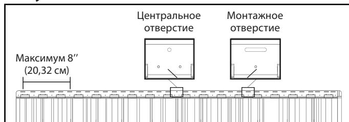
2. Запрещается забивать гвозди или закручивать крепежные детали до конца: нужно оставить зазор  $1/16"$  (0,16 см) между каналом для крепления гвоздями и шляпкой крепежной детали (рисунок 2). Обязательно нужно использовать нержавеющие гвозди или винты со шляпкой диаметром  $0,4"$  (1 см) и стержнем диаметром  $0,150"$  (0,38 см), которые должны проникать в твердую поверхность на расстояние не менее  $1\frac{1}{4}"$  (3,18 см), а в твердую основу как минимум на  $7/16"$  (1,11 см).
