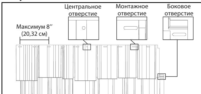
2. Запрещается забивать гвозди или закручивать крепежные детали до конца: нужно оставить зазор 1/16" (0,16 см) между каналом для крепления гвоздями и шляпкой крепежной детали (рисунок 2). Обязательно нужно использовать нержавеющие гвозди или винты со шляпкой диаметром 0,4" (1 см) и стержнем диаметром 0,150" (0,38 см), которые должны проникать в твердую поверхность на расстояние не менее 1 1/4" (3,18 см), а в твердую основу как минимум на 7/16" (1,11 см).
