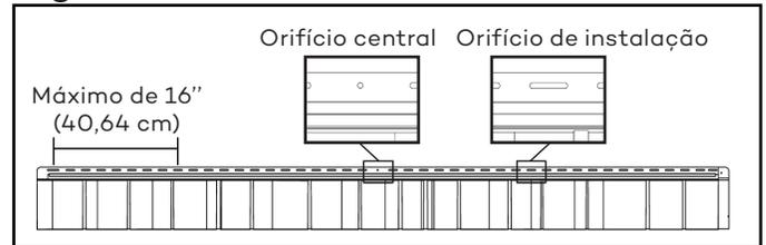
2 - Nunca martele ou fixe completamente os parafusos; deixe uma folga de 1/16" (0,16 cm) entre a canaleta e a cabeça do parafuso (Figura 2). Use sempre parafusos ou pregos não corrosivos com uma cabeça de 0,4" (1 cm) de diâmetro e corpo de 0,15" (0,38 cm) de diâmetro, penetrando-os em uma superfície sólida por, pelo menos, 1 1/4" (3,18 cm) e por um substrato sólido por, pelo menos, 7/16" (1,11 cm).
