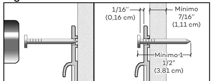
3 - Verifique se todas as peças estão unidas adequadamente empurrando-as firmemente para cima na seção a fim de garantir que a inserção esteja completa (Figura 3).
