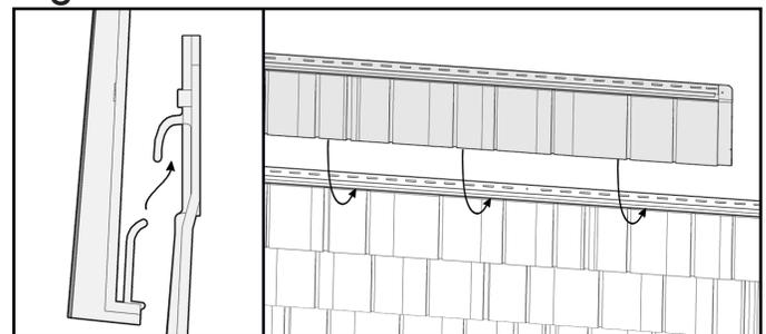
4 - Ao usar um corte de acabamento (canaleta J, cantoneira externa etc.), deixe um espaço de 1/4" (0,64 cm) entre o corte e a TandoShake (Figura 4). A abertura obrigatória para o corte de acabamento é de 3/4" (1,91 cm).
