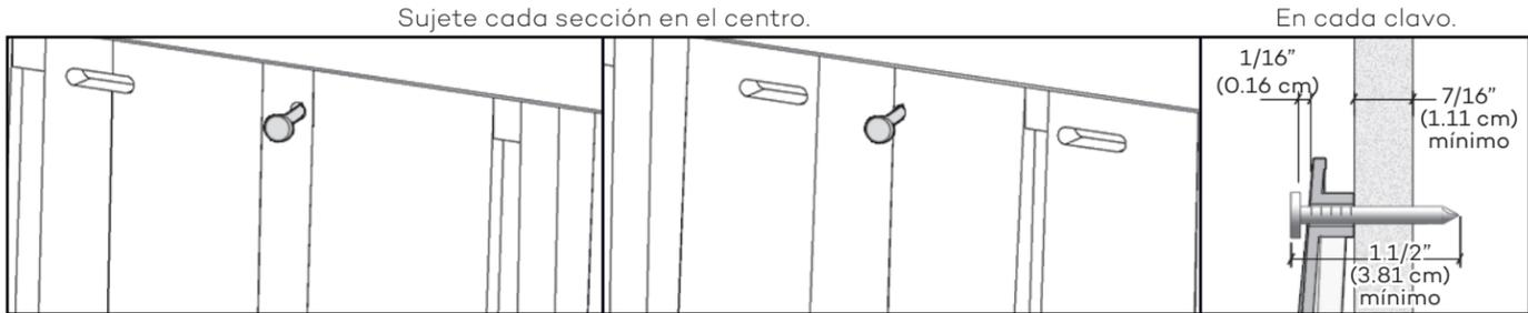
Quando se instale una sección completa, clave primero el orificio central. Cuando instale una sección cortada, clave el centro como se muestra.
