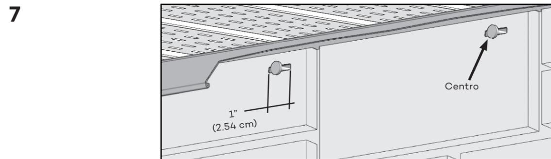
Si necesita sujetar la sección en un área diferente al orificio de instalación, cree una ranura larga de 1" (2.54 cm) para los clavos. Siempre coloque el clavo en medio de la ranura.
