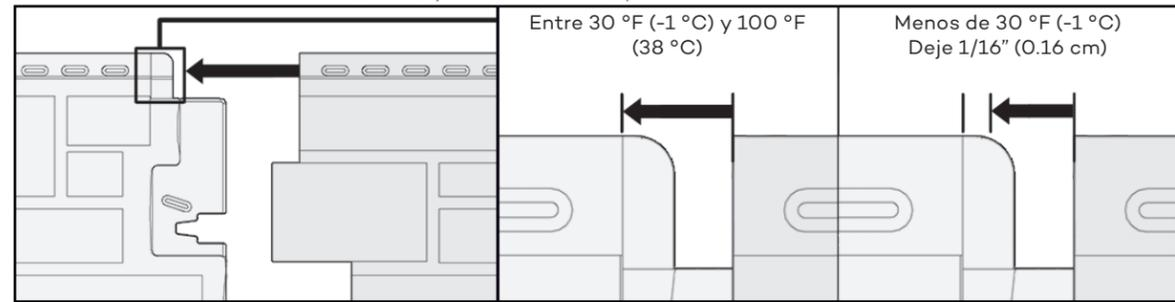
Menos de 30 °F (-1 °C), coloque la sección ligeramente hacia la derecha de la sección anterior (1/16" (0.16 cm)).
