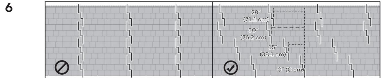
Altere las juntas entre las hileras. Para una apariencia más agradable, sugerimos que alterne la distancia de corte de la primera sección de cada hilera de 0" (0 cm) - 15" (38.1 cm) - 30" (76.2 cm) - 28" (71.1 cm).
