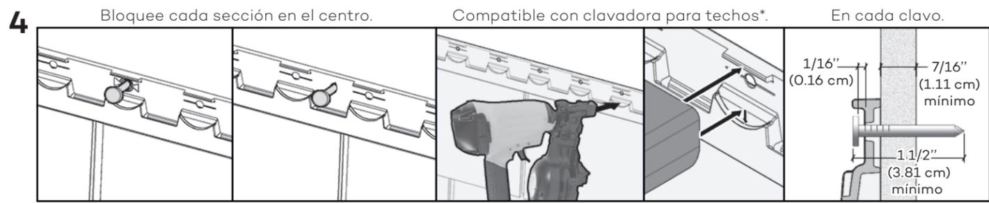
Quando se instale una sección completa, clave primero el orificio central. Cuando instale una sección cortada, clave el centro como se muestra. En cada clavo, deje un espacio entre la cabeza del clavo y la sección. Cuando use una clavadora para techos, ajuste la punta a su posición más alta y la presión del aire según el sustrato a fin de dejar el espacio requerido.
