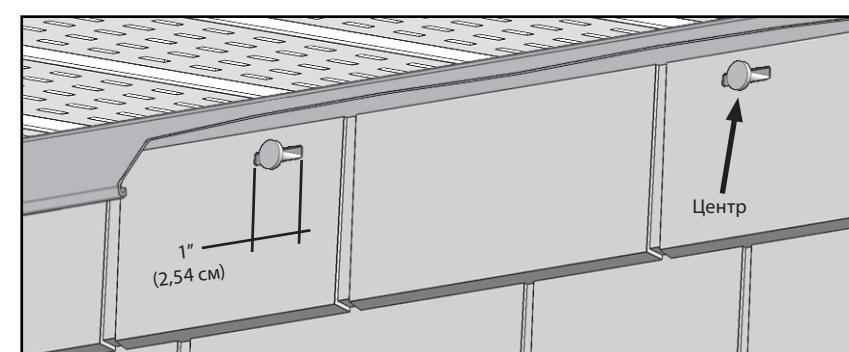
Если нужно закрепить секцию не через монтажное отверстие, прорежьте отверстие диаметром 1" (2,54 см), чтобы в него можно было забить гвоздь. Забивать гвоздь всегда нужно строго в середине отверстия.
